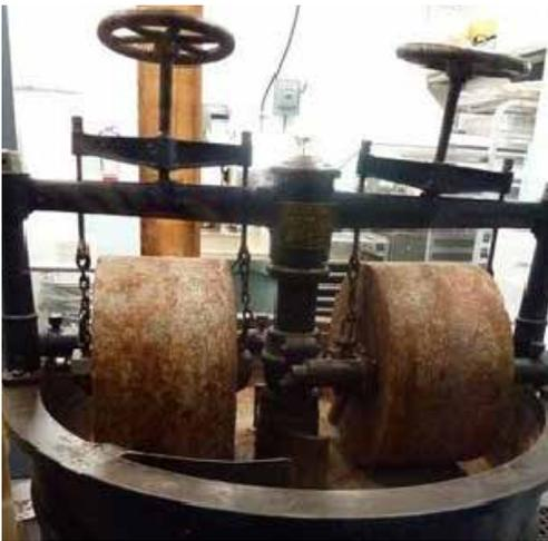
FIGURA 11: Prensa de cilindro rotativo
